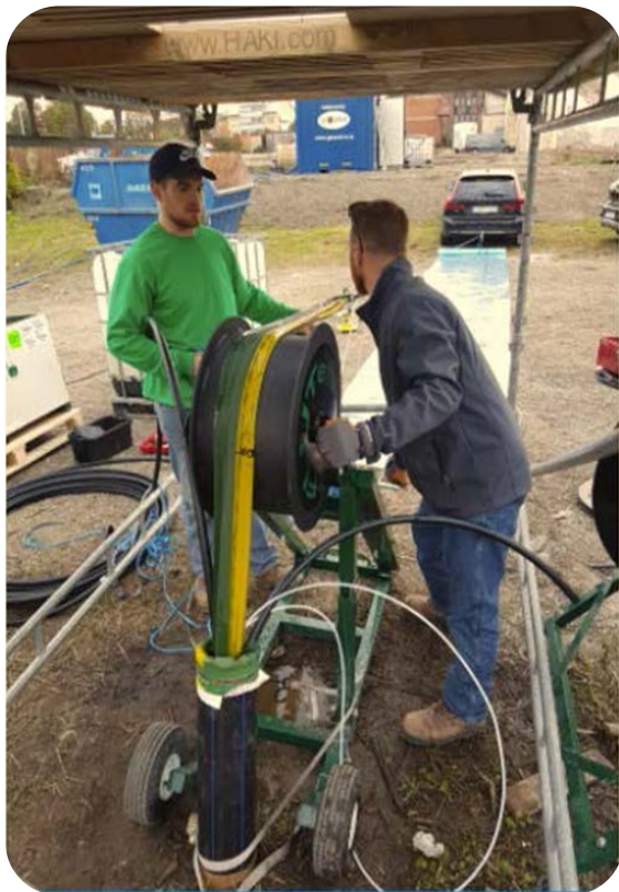
Bilderna visar den nya tekniken som användes, NAPL-FLUTE. Foto: Fredric Engelke, Structor.
