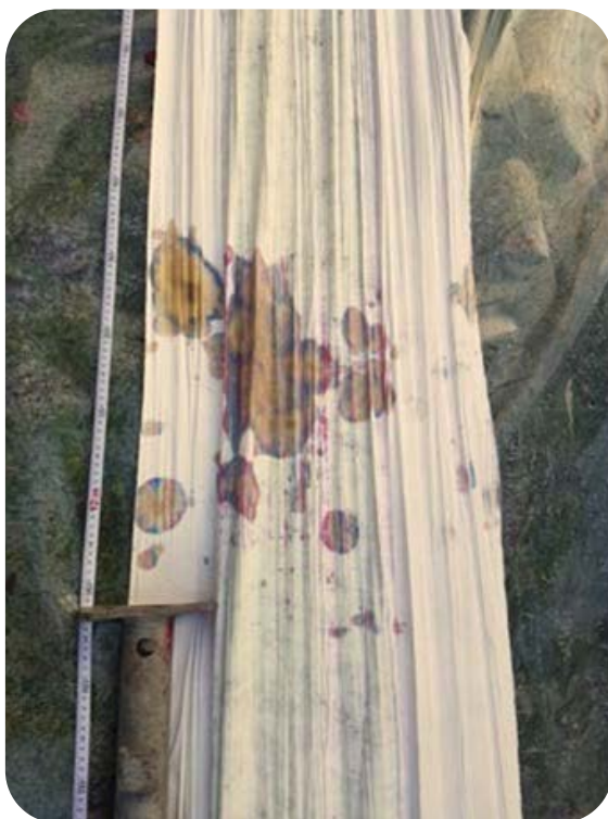
Bilderna visar den nya tekniken som användes, NAPL-FLUTE. Foto: Fredric Engelke, Structor.
