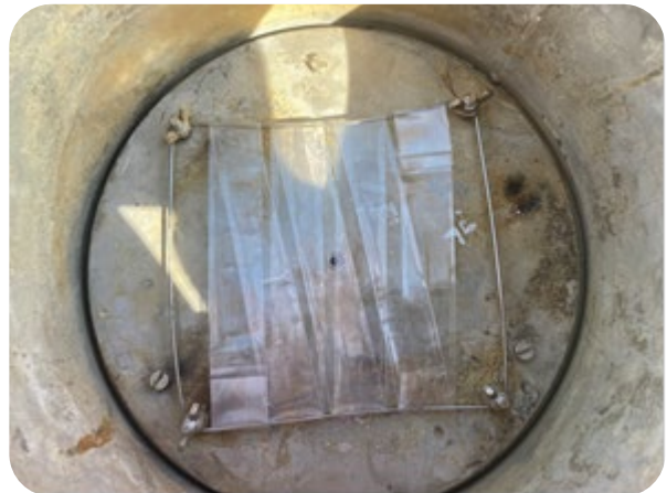
Passiv provtagning, diffusionskammare med SPMD-membran satt på en bygel. Foton: Thomas Pabst och Emma Flodin.
