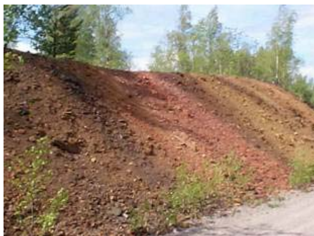
Röd, gul och svart sand pekar på att här förut funnits en kallrost. Denna rostplats ligger vid Kvarnbron.
