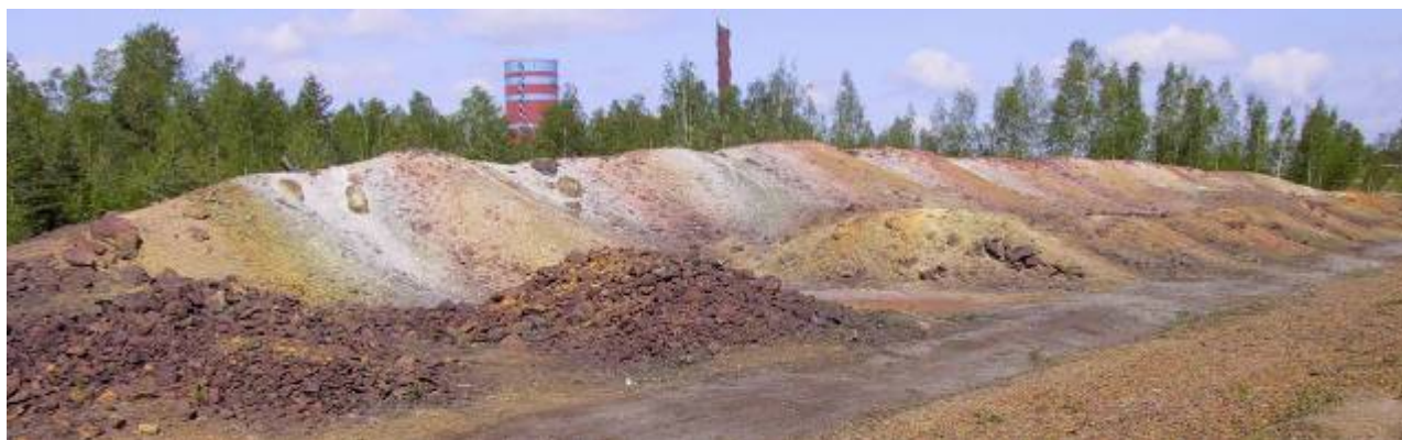
Kallrostlämningar vid Syrafabriksvägen. Här anlades 1862–63 sex rostbatterier med 6–8 rostbåsar i varje. Från båsen ledde 20 meter långa kanaler till ett svavelhus för att fälla ut svavlet ur den bildade svaveldioxiden. Dessa rostar var igång till 1905. Högarna innehåller rikligt med rent svavel.
