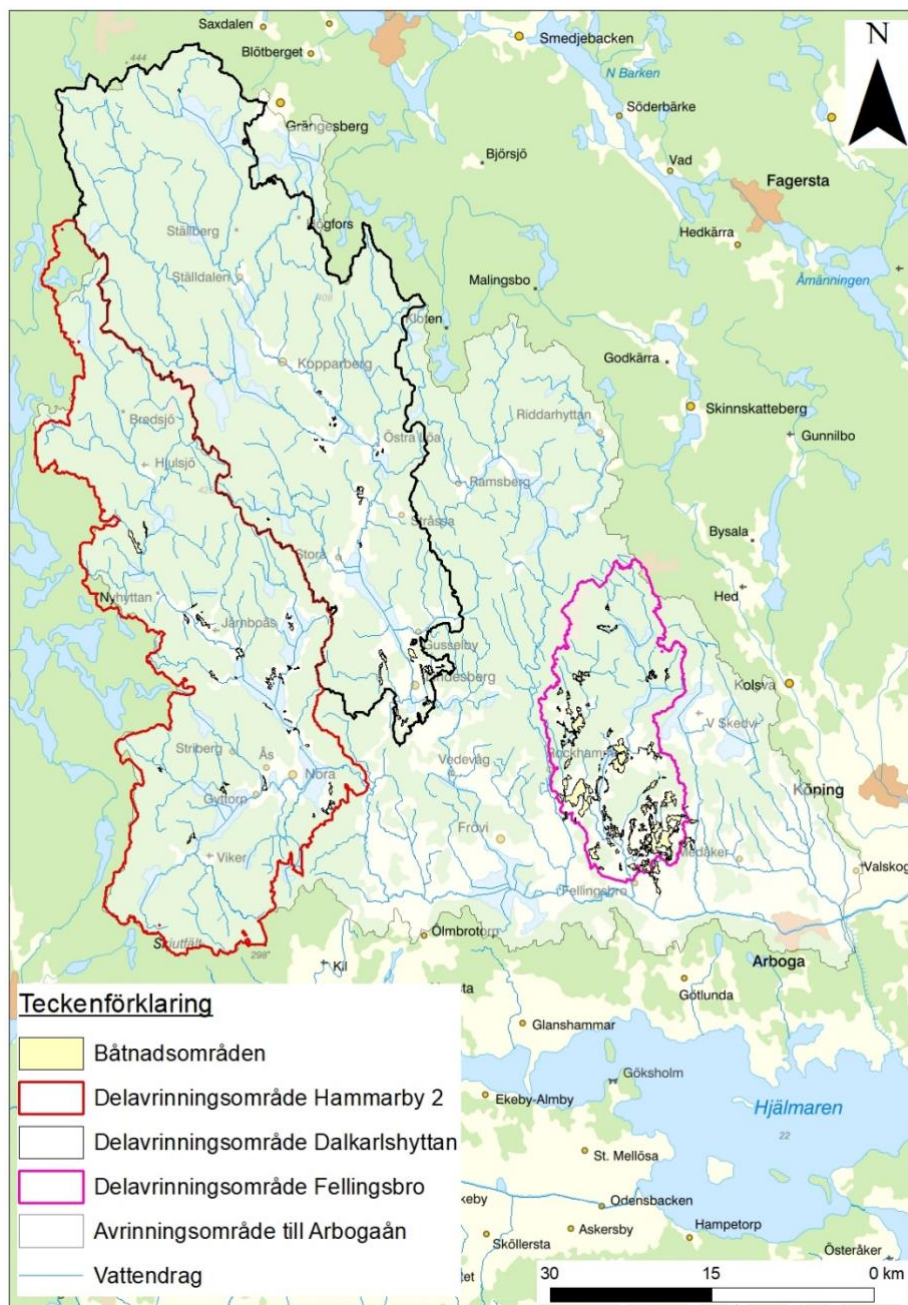
Figur 19. Arbogaåns avrinningsområde och de tre delavrinningsområdena som har mätstationer och som har använts i beräkningarna.
