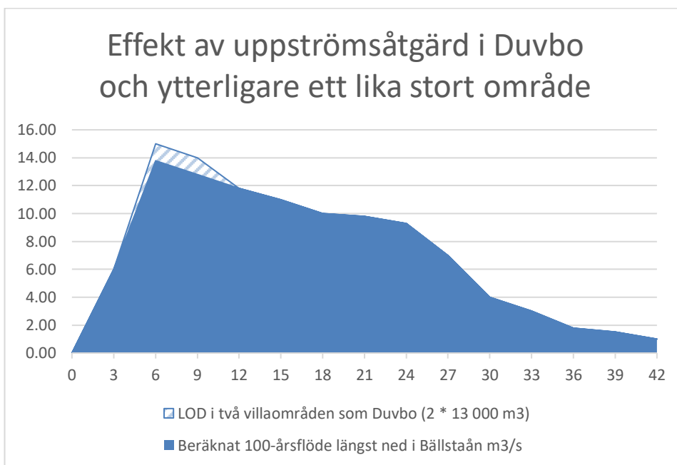
Figur 36. Om två villaområden som nämnts i kapitel 3 (Duvbo) konverteras till lokalt omhändertagande av dagvatten och håller vatten lokalt istället för att vara kopplade på ledning skulle volymen vid ett hundraårsregn kunna minska med den streckade ytan på diagrammet ( x axeln visar h, y axeln visar m 3 /s).
