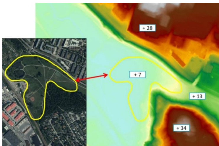
Figur 14. Exempel på en tillämplig plats (gul polygon) för en åtgärd nära vattendraget med kontroll av höjdförhållanden.
