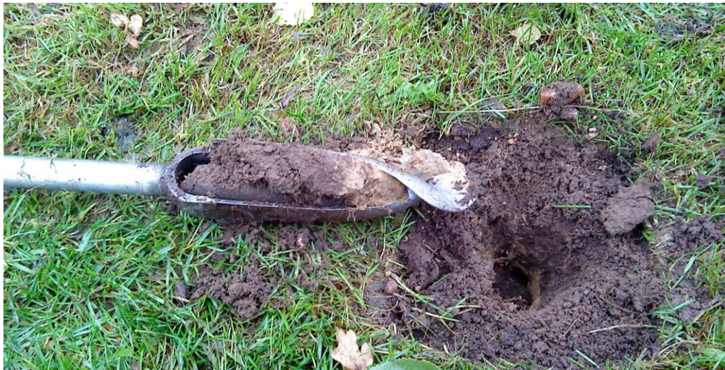
Figur 4-1 Provtagning med manuell skruv, Auger. Foto: SGI.
