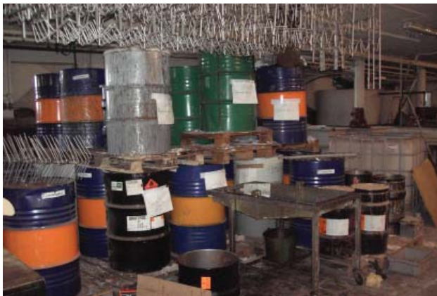
Bild 2: Tunnor innehållande metallhydroxidslam och processkemikalier.
