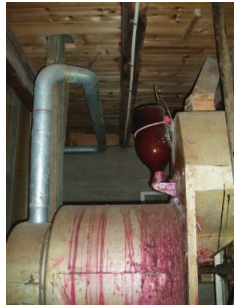
Bild 2: Betningsapparat med spår av rödfärgat betningsmedel.
