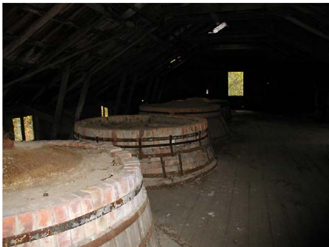
Figur 9 Tjärdalen, Lingbo. Toppen av ugnarna där veden matades i på övervåningen i fabriken. Foto Lena Hedberg.
