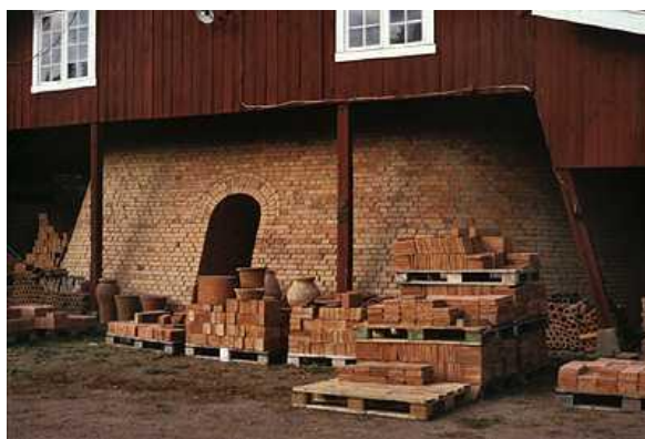
Bild 2.1 Horns tegelbruk i Västergötland är det enda bruk som ännu slår tegel för hand. Bilden visar en av ugnarna och exempel på tegelprodukter som bränts där. Foto: OAn (RAÄ, 2009)
