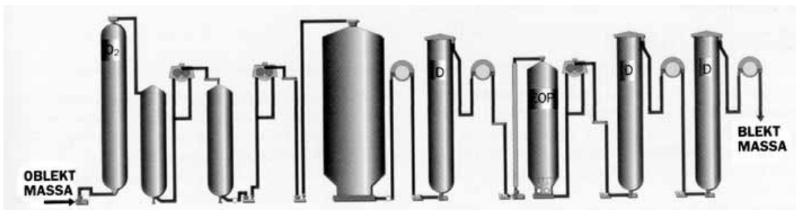
Blekeri utan klorgas. Blekning utan klorgas kallas ECF (Elementary Chlorine Free).
