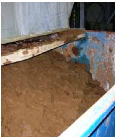
Figur 6. Metallhydroxidslam från ytbehandlingsanläggning i drift. (Foto: Annika Perhans)
