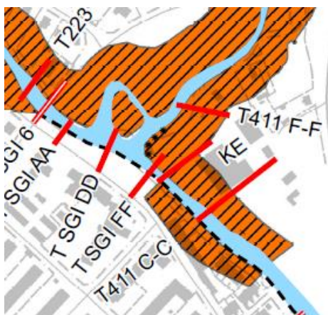
a) Jordrörelser. Översiktlig stabilitetskartering, karta 1B (MSB). Orange färg innebär att området översiktligt inte kan klassas som tillfredsställande stabilt. Svart raster innebär dessutom att området är särskilt angeläget att utreda vidare (stabiliteten är låg), se Tabell 4.2 och Avsnitt 4.3.2. (Källa: MSB)
