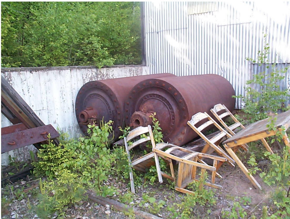
De två bevarade valsarna från torkmaskinen ligger kvar vid det nya pappmagasinet.
